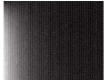
Die Erwärmung durch den links im Bild liegenden Ausleseverstärker erhöht dort den Dunkelstromeffekt
